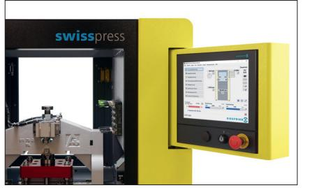
Die Siegfried Advanced Software SAS integriert die **Steuerung** der Presse sowie der gesamten Peripherie in einem einzigen System. Dies gewährt höchsten Bedienkomfort, Effizienz und Flexibilität. Die Steuerung kann bei Bedarf jederzeit mit weiteren Modulen kundenspezifisch ergänzt und angepasst werden. Sämtliche Parameter für Presse, Überwachung, Vorschub und Beölzung werden auf einer einheitlichen Oberfläche bedient und in einem gemeinsamen Datensatz gespeichert.
