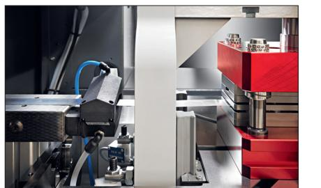
Bei der **Beölzung** des Stanzstreifens, mit der Siegfried Advanced Lubrication SAL, können minimalste Ölmengen exakt dosiert und perfekt reproduzierbar aufgetragen werden. Die Anlage kann bei Bedarf mit weiteren Modulen, für die punktgenaue Beölzung direkt im Werkzeug, ergänzt werden. Sämtliche für den Betrieb notwendige Komponenten wie Kanister für Frisch- und Restöl, die Sprühkammer, sowie die LubeCubes mit den Präzisions-Zahnradpumpen sind im Schutzgehäuse der Anlage integriert.
