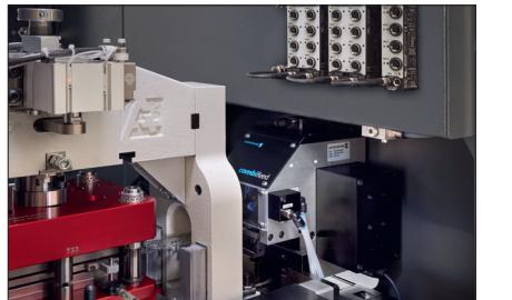
Als **Vorschubgerät** kommt der bewährte Siegfried-CombiFeed zum Einsatz. Der Antrieb erfolgt über einen Servomotor. Die spielfreie Koppelung der beiden Walzen sorgt für eine äußerst hohe Präzision. Der Anpressdruck wird pneumatisch mit beidseitig einstellbaren Anschlägen für die Begrenzung der Walzenlüftung eingestellt. Über die Handbedienung können die meistverwendeten Funktionen, sowie die Zustimmung für sicheres Vorschieben bequem bedient werden.
