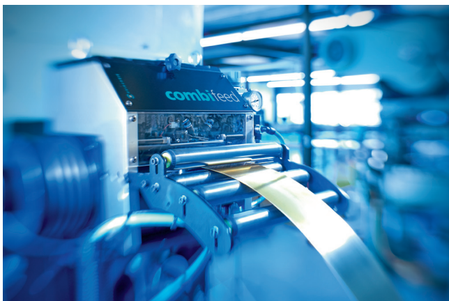
Bild 1: Das neue CombiFeed-System der Heinz Siegfried AG kombiniert bewährte Vorschubtechnik mit einem innovativen Beölungssystem
